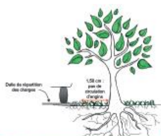
Schéma n°1 : Dalle de répartition des charges pour le passage des engins lourds (voir notice)
